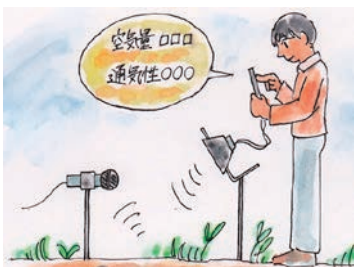
図1 土壌に音を当てる実験のイメージ スピーカーから音を出し、マイクで音を拾う。
