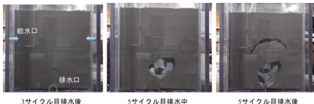
図1 模型実験による空洞形成の様子
